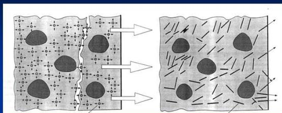
Smanjenje pritiska para u betonu izloženom požarnom opterećenju ugradnjom polipropilenskih vlakana
