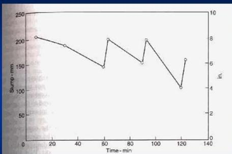
Utjecaj dodatnog doziranja superplastifikatora na bazi naftalena na konzistenciju betona mjerenu slump metodom (Neville, 1995).
