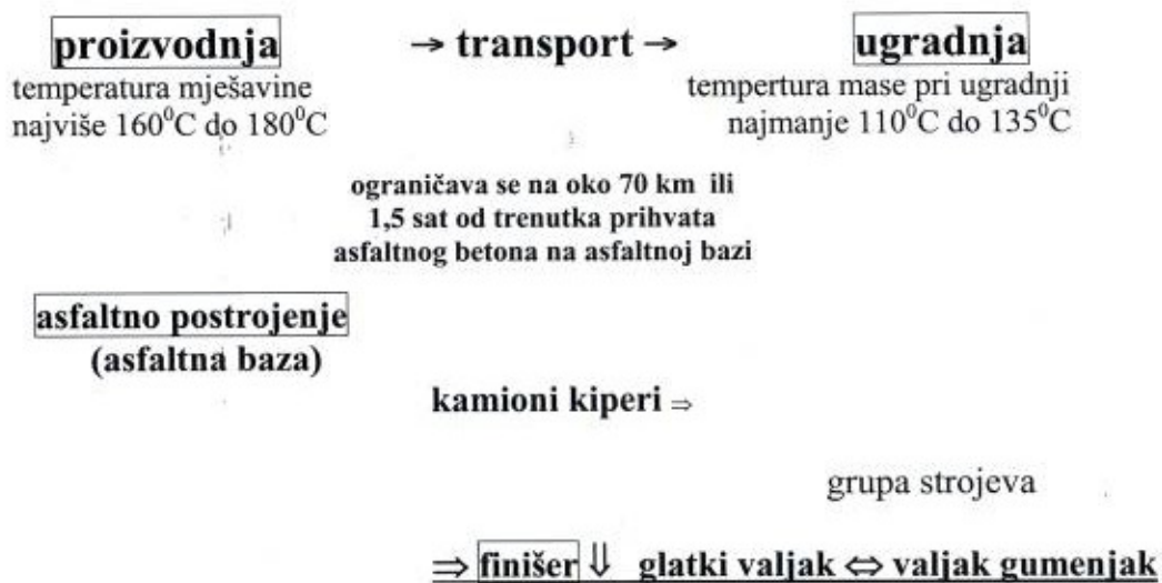
Slika 2.3.3.1: Tehnološki postupak i pripadni strojno-tehnološki sustav pri izvedbi asfaltnih kolničkih konstrukcija od vruće miješanih valjanih asfaltnih betona
