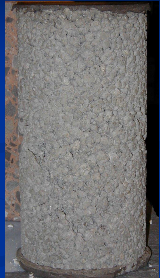
Uzorak mikroarmiranog betona s malom količinom veziva i sitnog agregata
