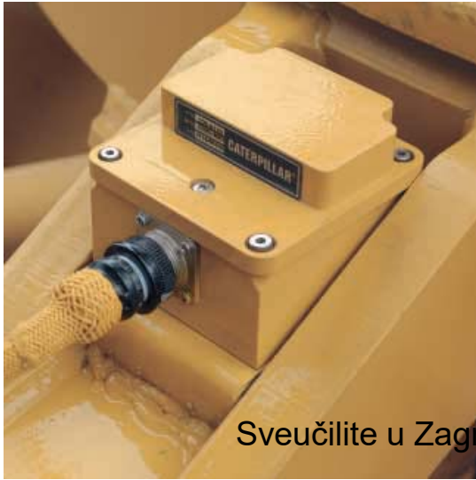
Senzor kuta noža (lijevo) i senzor rotacije noža (desno)
