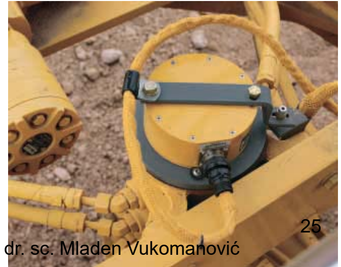
Senzor kuta noža (lijevo) i senzor rotacije noža (desno)
