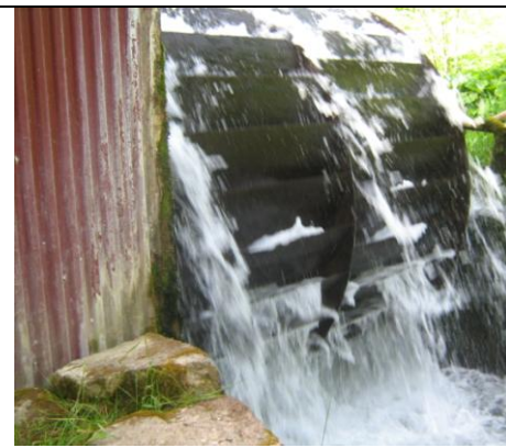
Vodno kolo u primjeni danas, mala hidroelektrana u Bavarskoj instalirane snage cca 40kW
