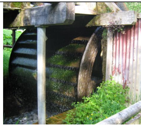
Vodno kolo u primjeni danas, mala hidroelektrana u Bavarskoj instalirane snage cca 40kW
