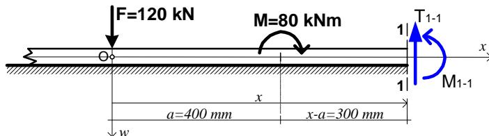
Normalno naprezanje u točki C:  $\sigma_x^C = \frac{M_{1-1}}{I_y} \cdot z_C = -9,65 \text{ MPa}$  (tlak)
