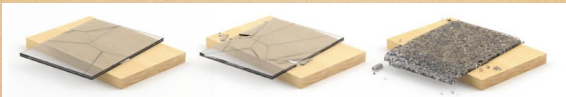
Lamelirano sigurnosno staklo – 45 N/mm 2
