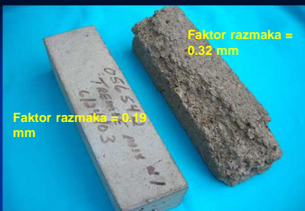
Izgled uzoraka koji su prošli 300 ciklusa smrzavanja i odmrzavanja prema ASTM C 666
