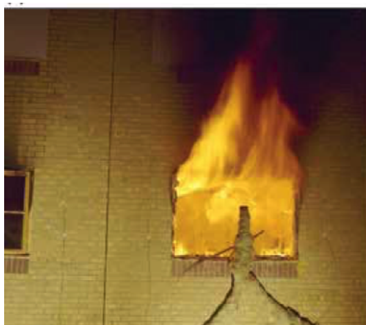
Slika 8 Izlazak plamena nakon rasplamsavanja kroz otvor na zidanoj zgradi [10]
