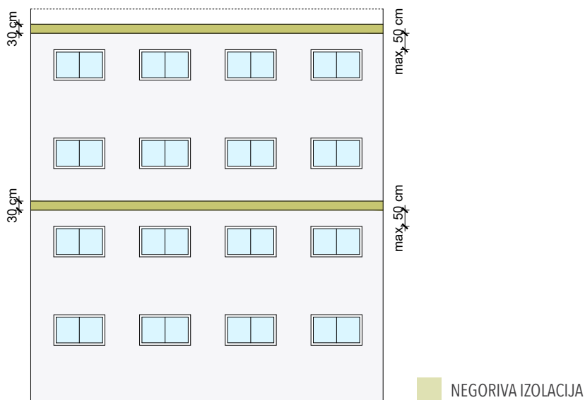
Slika 33 Sprečavanje vertikalnog širenja požara pomoću horizontalnog kontinuiranog pojasa od negorivog materijala ugrađenog na pročelju svake druge etaže [15]
