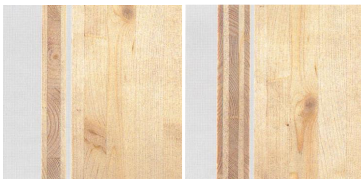
Slika 4.1 Višeslojne križno lamelirane drvene ploče – troslojne i petoslojne ploče od punog drva
