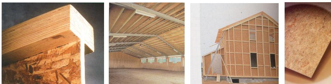
Slika 4.12 Primjena i konstrukcija OSB ploča
