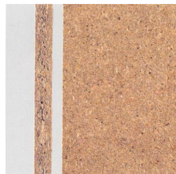
Slika 4.13 Konstrukcija ploča iverica
