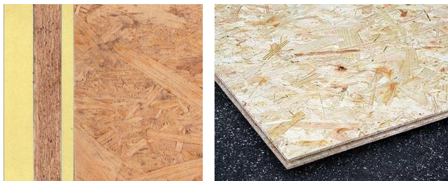
Slika 4.11 Konstrukcija OSB ploča
