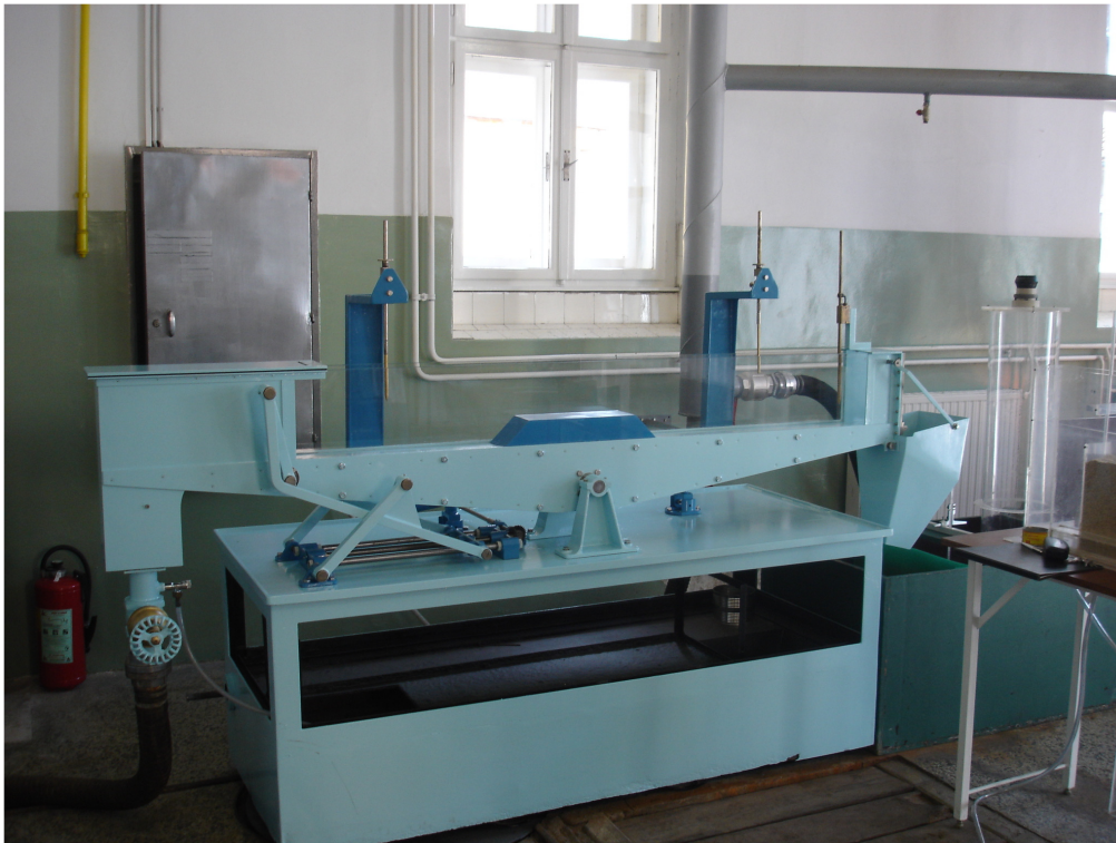
Slika 3.1 Mali stakleni žlijeb sa ugrađenim širokim pragom
