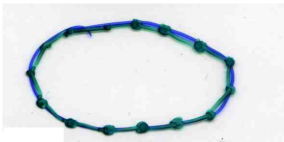
Slika 5.14 Primjer diskretizacije sheme za metodu rubnih elemenata
