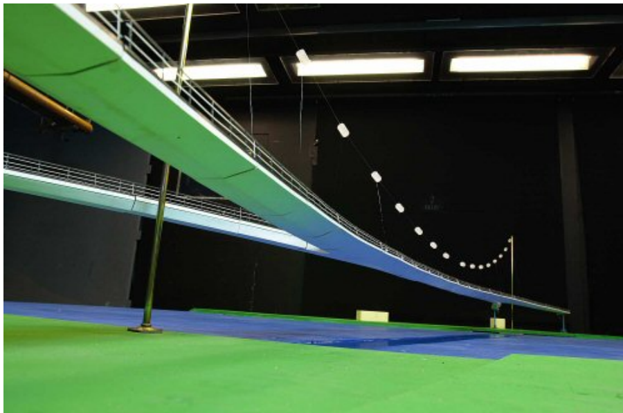
Slika 8.7. Primjer modela mosta u vjetrovnom tunelu
