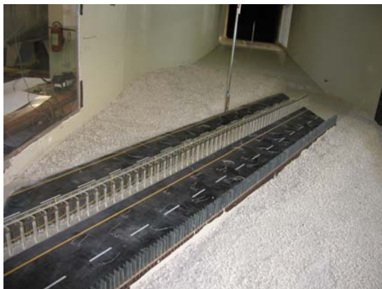
Slika 8.20 Segmentni vjetrobrani – model ispitivan u zračnom tunelu (lijevo) i probno polje (desno)
