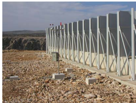
Slika 8.20 Segmentni vjetrobrani – model ispitivan u zračnom tunelu (lijevo) i probno polje (desno)
