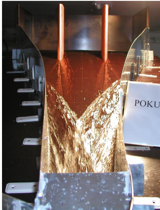
Slika 4a,b Dio fizikalnog modela cijelokupnog hidrauličkog sustava HE Ombla (lijevo – fizikalni model sa mjerilom duljina 18, IGH-Zagreb ; desno - pokus sa stacionarnim preljevnim protokom Q = 60\text{m}^3/\text{s} kroz dionicu preljevnog brzotoka na fizikalnom modelu sa mjerilom duljina 30, GFZ-Zagreb) 3. Rezultati modeliranja
