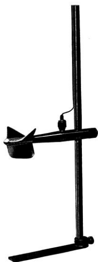
Slika 4.2::2 Hidrometrijsko krilo koje se koristi u laboratorijima i u manjim kanalima
