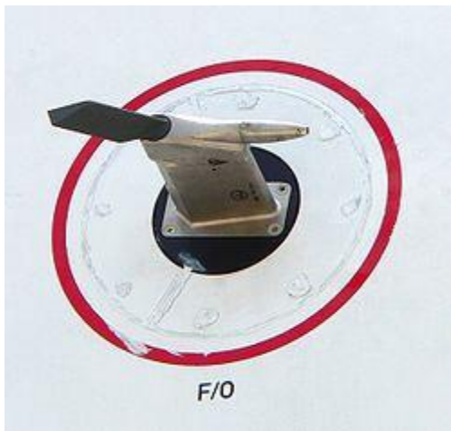
Slika 4.2::4 Pitot-ova cjevčica ugrađena na Airbus A 380
