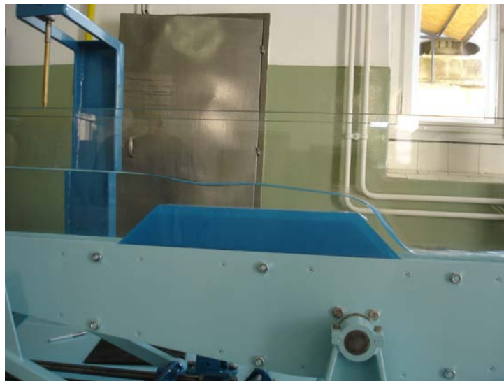
Slika 3.3 Prelijevanje preko širokog praga
