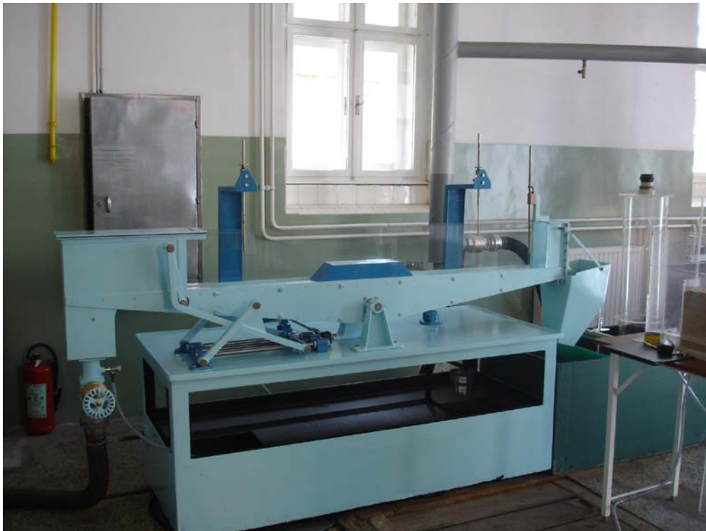
Slika 3.1 Mali stakleni žlijeb sa ugrađenim širokim pragom
