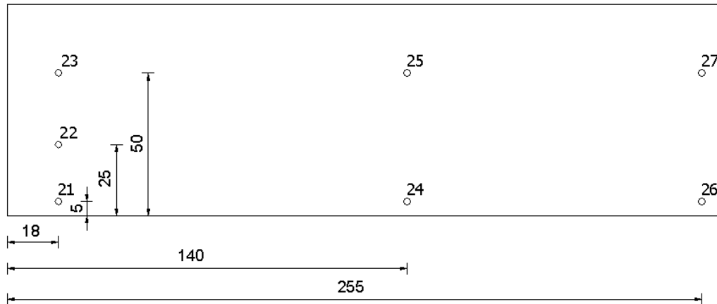
Slika 12.6 Položaj piezometara na boku
