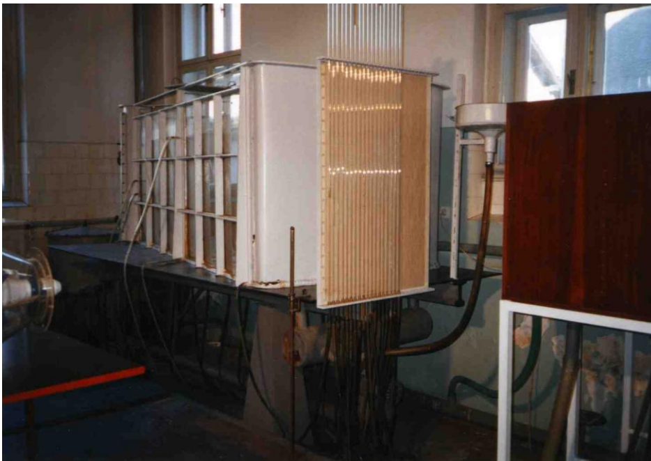
Slika 12.1 Fizikalni model radijalnog strujanja prema zdencu
