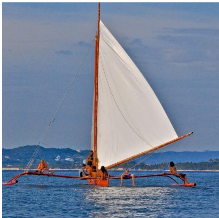
Slika 7-1 Polinezijska jedrilica s dva bočna pomoćna trupa – outriggera - koji stabiliziraju glavni trup
