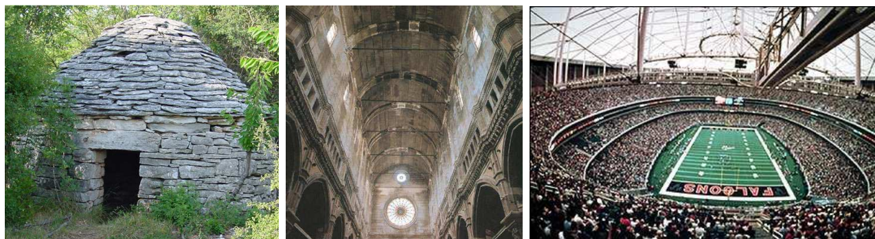
Slika 269.: Plošne konstrukcije: a) istarski kažun (slična je i dalmatinska bunja), b) svod Šibenske katedrale, c) krovšte stadiona Georgia Dome, Atlanta, SAD
