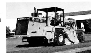
**rovokopači, trenčeri** (engl. *trencher*, njem. *Grabenbagger*, m., *Grabenfräse*, f.), posebna vrsta konstrukcije →bagera za neprekidni iskop razmerno uskih i dubokih rovova u tlu i stijeni. Uobičajeno se zovu trenčeri.
