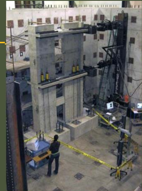
Ispitivanje zgrade u laboratoriju, potres se simulira guranjem i povlačenjem zgrade pomoću hidraulike
