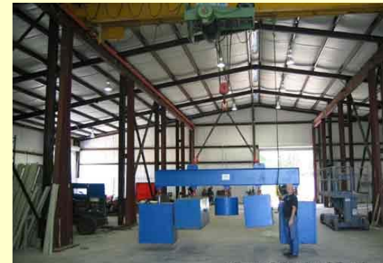
Dinamičko opterećenje kрана
