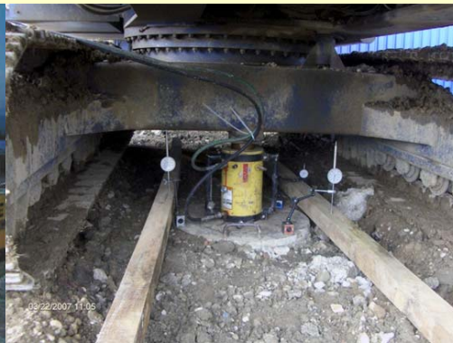
Probno opterećenje pilota
