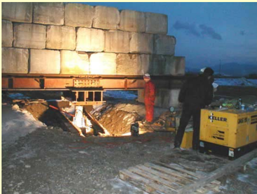
Probno opterećenje pilota
