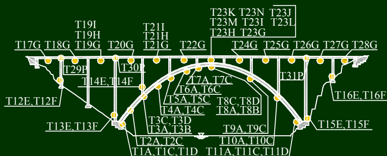
Raspored senzora za monitoring nosivosti Masleničkog mosta
