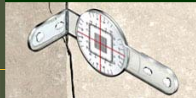
Mjerenje širine pukotina
