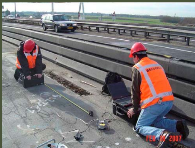
Ultrazvučno ispitivanje debljine kolničke ploče i pronalazak šupljina
