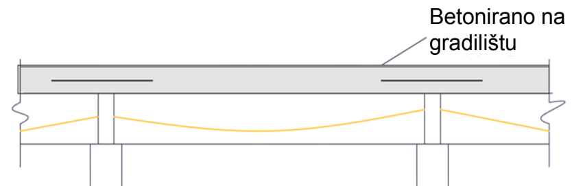
Spregnuti presjeci s nenapetom armaturom za kontinuitet
