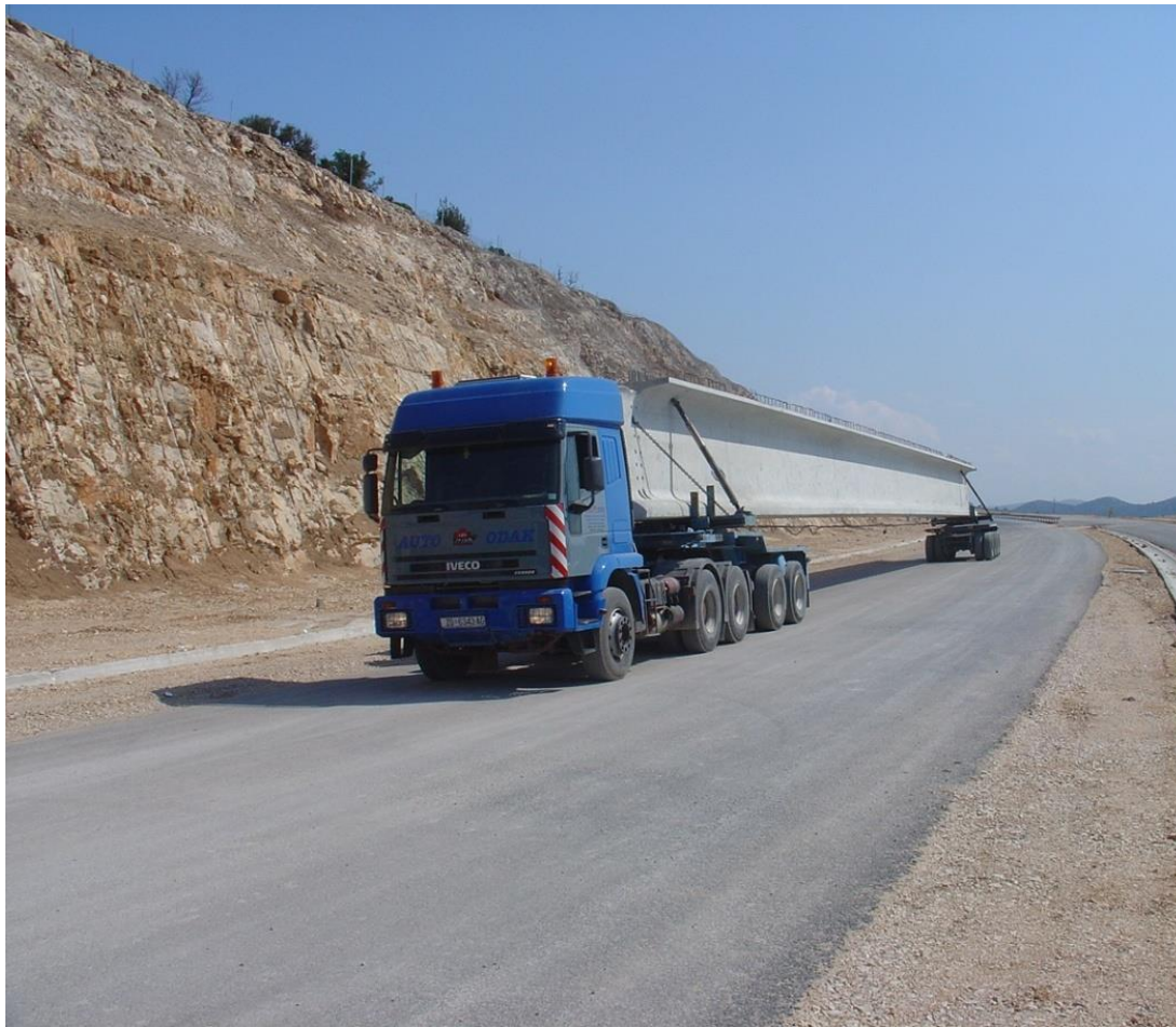
prijevoz AB nosača mosta posebnim vozilom
