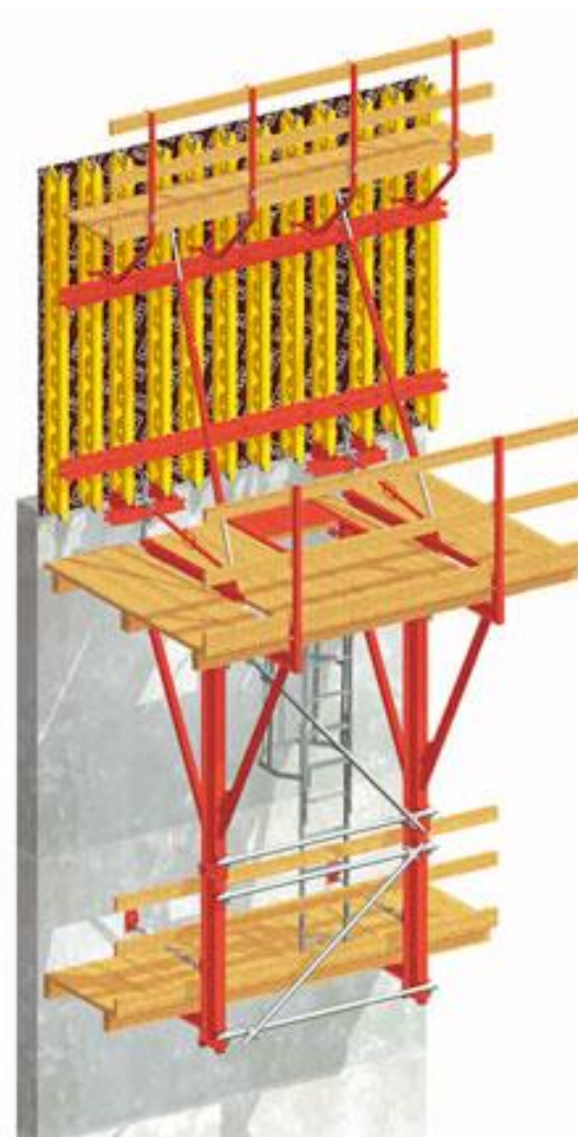
primjer sustava samopenjajuće (klizne) oplate stupa mosta
