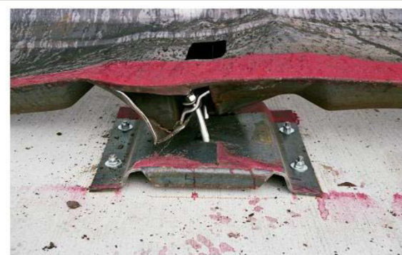
Primjeri oštećenja sidrenja zaštitnih ograda
