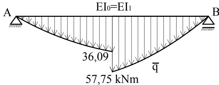
To opterećenje možemo radi jednostavnosti zamijeniti rezultantnim silama za pojedine dijelove dijagrama (rezultanta je jednaka površini dijela dijagrama a djeluje u težištu te površine):
