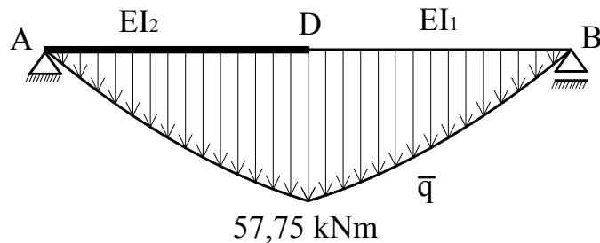
Budući da izrazi za progib i kut zaokreta vrijede za nosač konstantne fleksijske krutost, a to ovdje nije slučaj, svodimo početni fiktivni nosač na fiktivni nosač s konstantnom krutošću. Istovremeno, moramo reducirati fiktivno opterećenje. Ako s  $I_0$  označimo jedan od aksijalnih momenata tromosti, onda reducirano fiktivno opterećenje  $M^*$  možemo izraziti kao:
