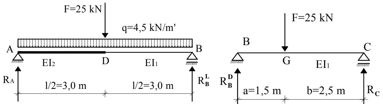
Za određivanje progiba na gredi AB potreban nam je dijagram momenata savijanja na gredi AB, a za određivanje skraćenja  $\Delta h$  potrebna nam je tlačna sila u štapu BH koja iznosi
