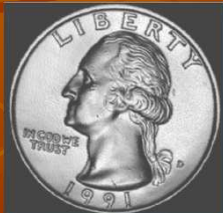
Slika dobivena zvukom reflektiranim s gornje površina novčića
