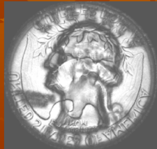
Slika dobivena zvukom reflektiranim s donje površina novčića
