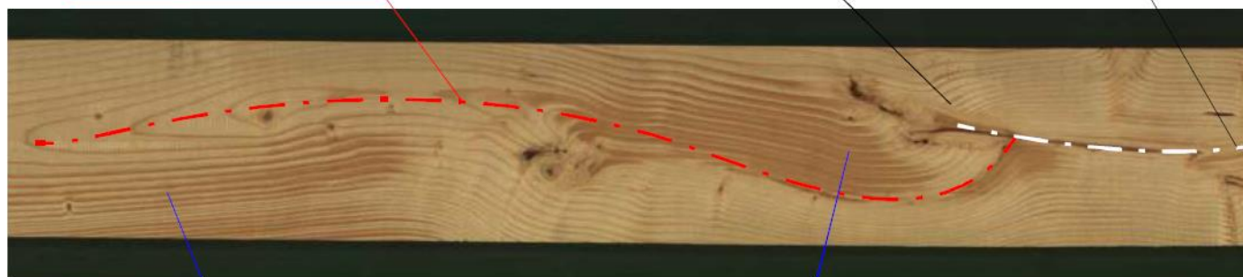
Devijacije vlakana do zone vrha pukotine / tlačno reakcijsko drvo na rubovima
