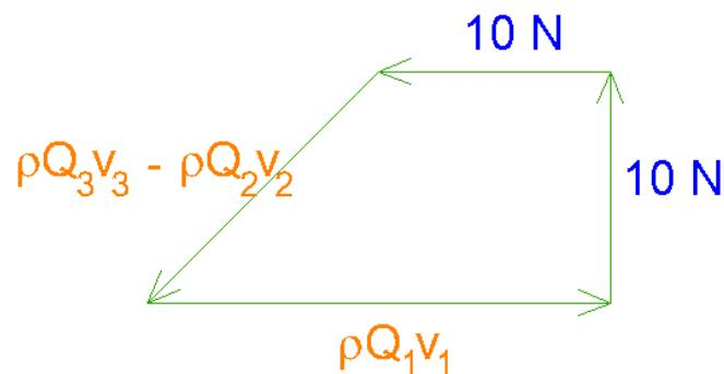
$$\text{očitano: } \rho Q_1 v_1 = 20 \text{ N} \quad \rightarrow \quad Q_1 = \frac{20}{\rho v_1} = \frac{20}{1000 \cdot 1} = 0,02 \text{ m}^3 / \text{s} = 20 \text{ l/s}$$
