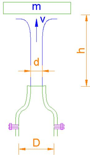
$$\rho Q_h v_h = mg \quad (\text{protok } Q_h \text{ je manji od protoka kroz cijev i sapnicu i, da nema utega, smanjiva bi se sve do najviše točke dosega mlaza, gdje bi iznosio nula})$$
