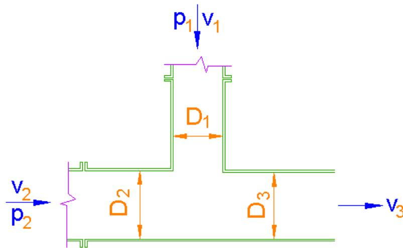
$$A_1 v_1 + A_2 v_2 = A_3 v_3$$
