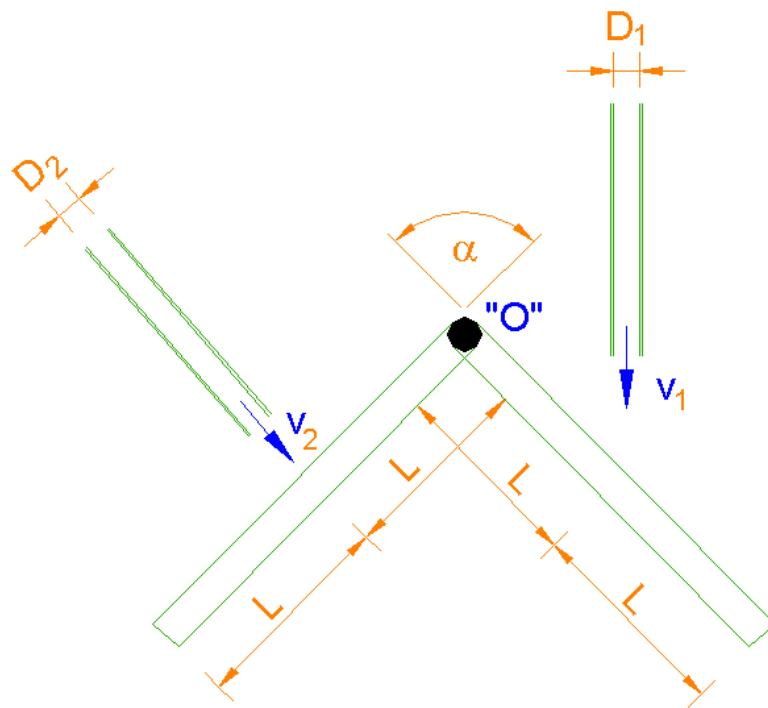
$$v_1 = \frac{4Q_1}{D_1^2 \pi} = \frac{4 \cdot 0,01}{0,065^2 \pi} = 3,01 \text{ m/s}$$
