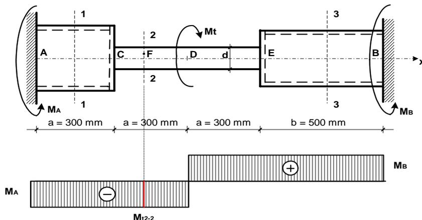
Iz zadanog posmičnog naprezanja u točki F presjeka 2-2 možemo odrediti moment torzije u presjeku 2-2 koji uzrokuje naprezanje  $\tau_F$ .
