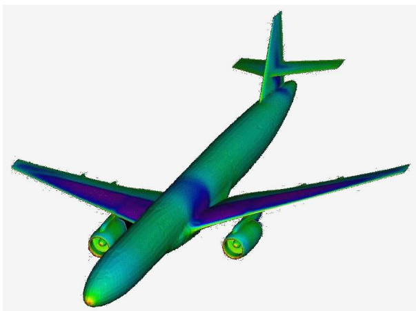
Slika 219.: Model aviona i pripadajućeg volumena zraka (koji nije prikazan zbog jasnoće slike). Trebalo je riješiti nelinearni sustav od približno 10^9 nepoznanica.
