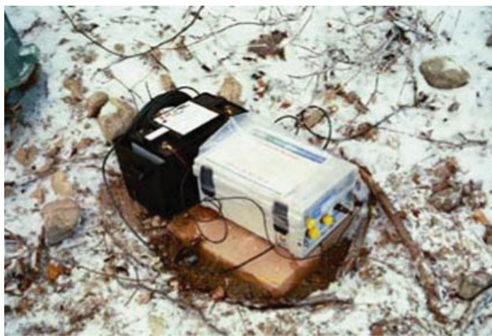
Slika 99.: Akceleroigraf izvor: http://en.wikipedia.org/wiki/Accelerograph
