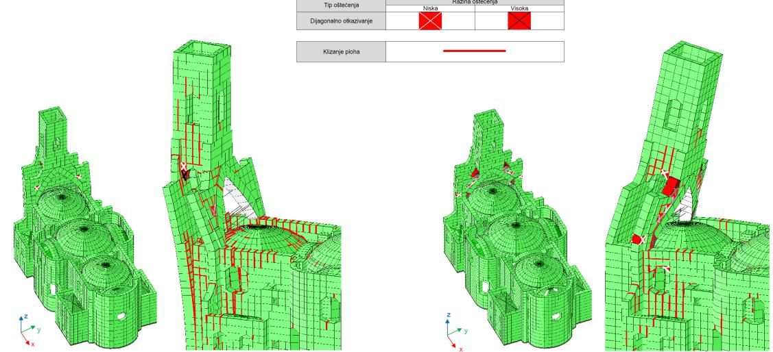
Slika 5-27 Prikaz oštećenja - Push-over u smjeru -x
