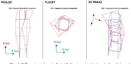
Slika 4-46 Eksperimentalno određeni oblik titranja s pripadajućom vlastitom frekvencijom [Ton 2 = 4,094 Hz]
