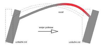
Slika 5-34 Vlačna zona svoda uslijed potresa
