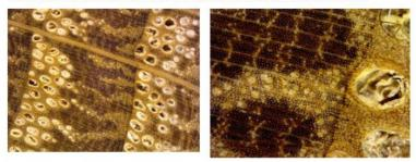
Slika 13 a) i b). Mikrografije pokazuju ravnomjeran, višeredan raspored pora u ranom drvu i vrlo gusto kasno drvo s radijalnim nizovima uskih pora (10x, lijevo), te velike pore ranog drva zapunjene tilama, kao i zdrav paratrahealni parenhim kako u ranom, tako i kasnom drvu (desno, 50x)
