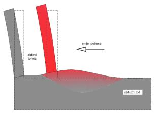
Slika 5-33 Vlačna zona zida uslijed djelovanja potresa na toranj
