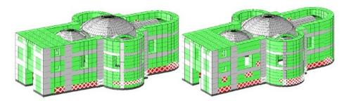
Slika 5-24 Prikaz oštećenja- Push-over u smjeru +x i – x
