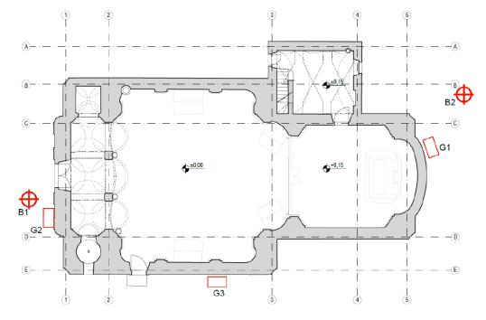
Slika 4-22 Položaj geotehničkih bušotina i istražnih jama
