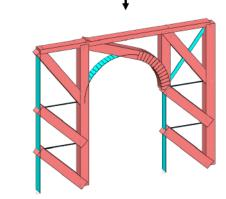
Prema gore prikazanim zonama vlačnih (plavo), odnosno tlačnih naprezanja (crveno), postavljeni su zamjenski štapni elementi prikazani u proračunskom modelu 2.
