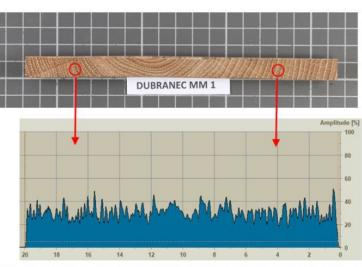
Slika 12 a) i b). Mjerno mjesto MM 1, vezna greda do tornja, izvrtak 12,5 mm. Potpuno zdrav i kompaktan presjek pokazuje ravnomjeran raspored i gustoću godova (gore, slika a) i primjeren otpor prodiranju rezistografske igle (dijagram).
