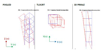
Slika 4-45 Eksperimentalno određeni oblik titranja s pripadajućom vlastitom frekvencijom
