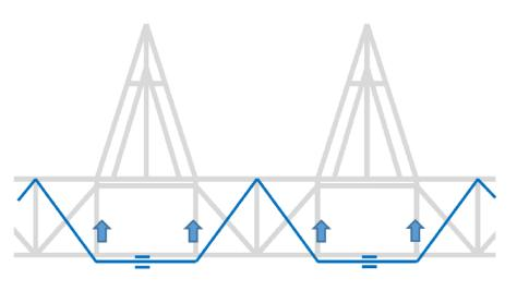
Slika 2- 15 Shematski prikaz pojačanja dvostruke visulje zone krovnih kućica
