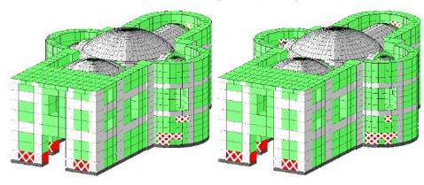
Slika 5-25 Prikaz oštećenja- Push-over u smjeru +y i – y
