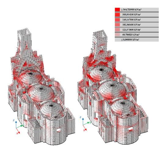
Slika 5-35 Prikaz vlačnih naprezanja - Push-over u smjeru +x i – x
