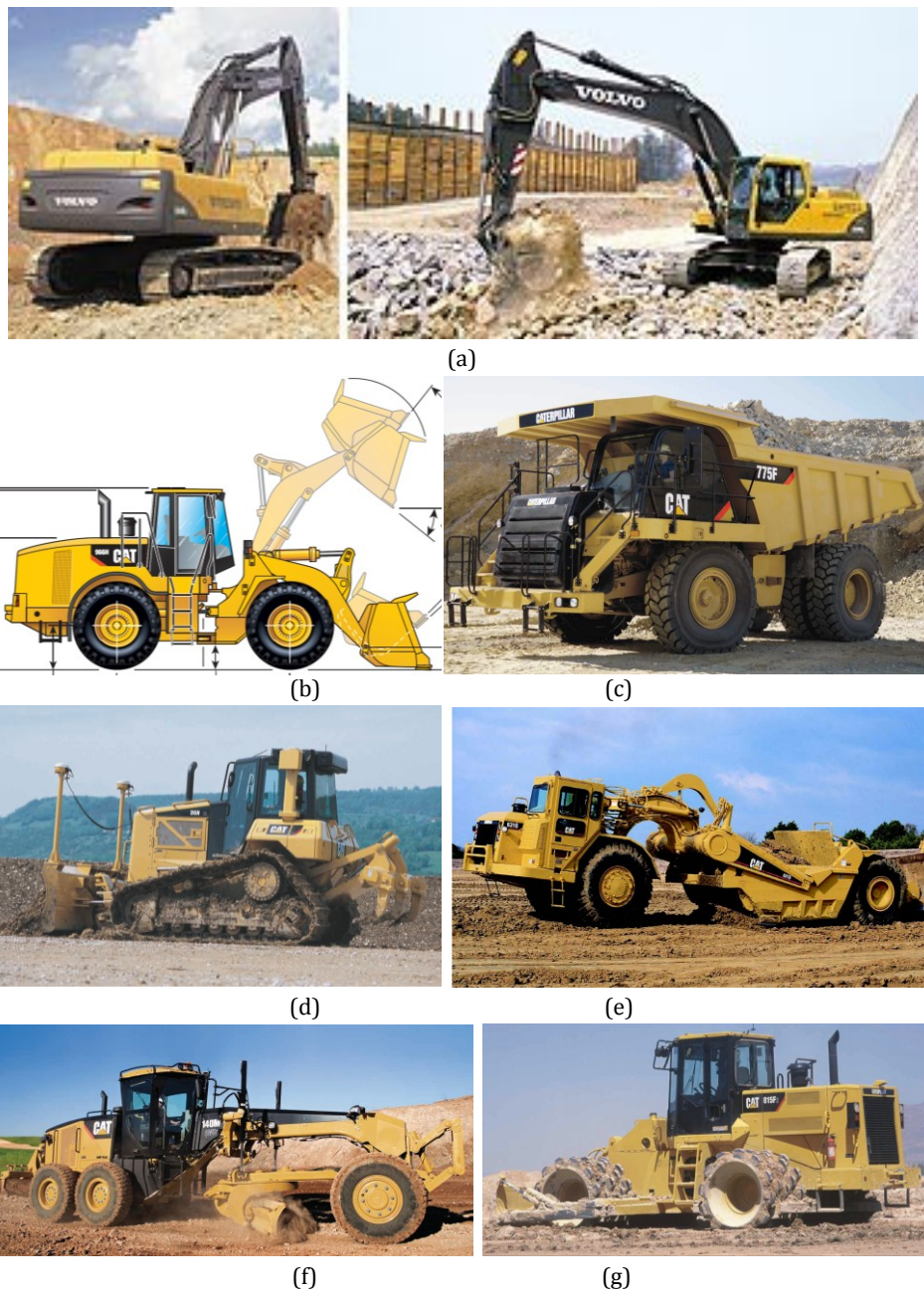
Slika 7-1 Tipični strojevi za zemljane radove: (a) bageri za iskop i utovar, (b) utovarivač za utovar iskopanog tla, (c) dumper za prijevoz tla, (d) dozer za razastiranje s plugom za plućenje, (e) skrejper za grubo ravnanje i razastiranje, (f) grejder za fino ravnanje, (g) valjak sa stopama za gnječenje i zbijanje sitnozrnog tla prirodnim sušenjem za lijepog vremena, što znatno ograničava takvu aktivnost, a u drugom se razastrtom tlu dodaje voda prskanjem.
