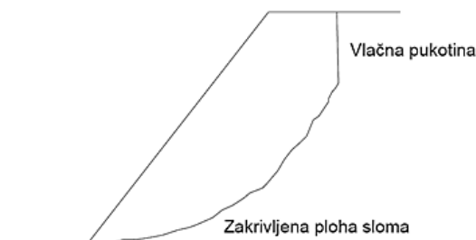
Rotacijski slom s vlačnom pukotinom
