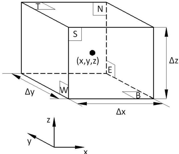
Za stranice se primjenjuje se nomenklatura  $N$ ,  $S$ ,  $E$ ,  $W$ ,  $T$  i  $B$ , sa značenjem Sjever (North), Jug (South), Istok (East), Zapad (West), Vrh (Top) i Dno (Bottom). Težište elementa je locirano koordinatom  $(x, y, z)$ .
