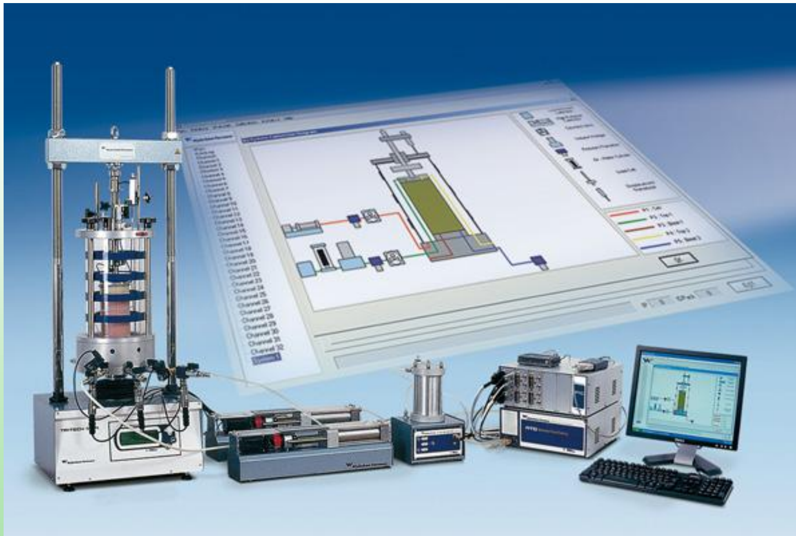
Primjer laboratorijskog sustava opreme za provođenje pokusa troosnog smicanja
