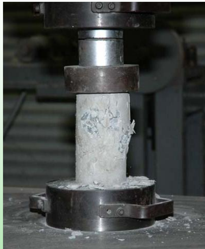
BETON – ispitivanje tlačne čvrstoće u preši
