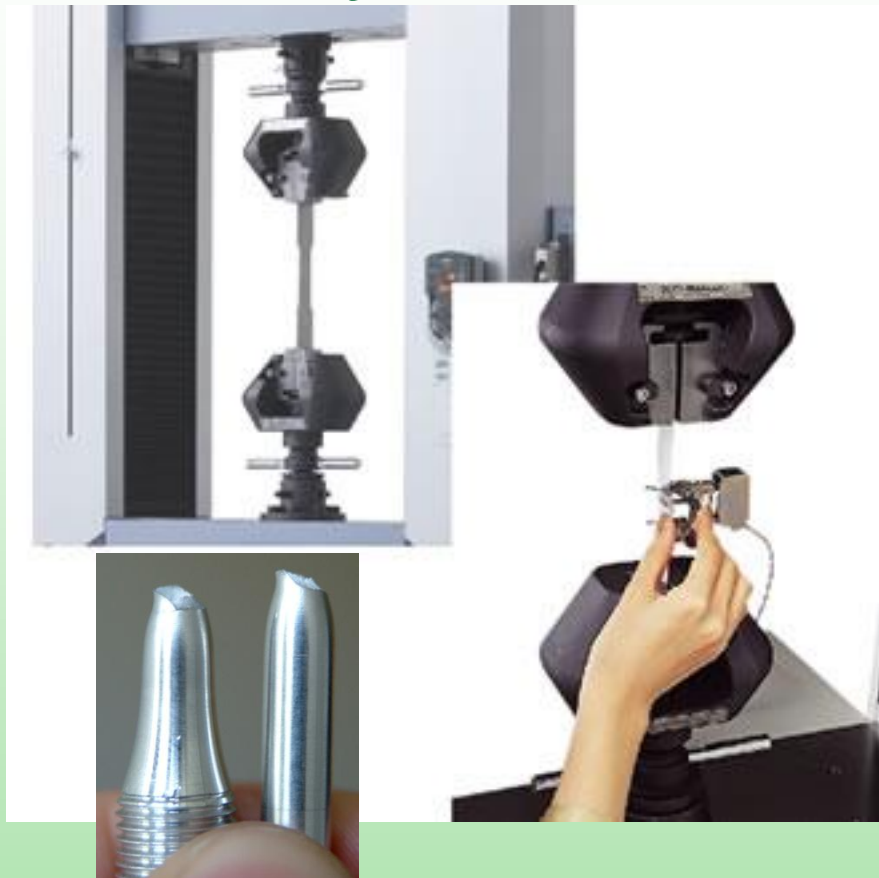
ČELIK – ispitivanje vlačne čvrstoće u kidalici
