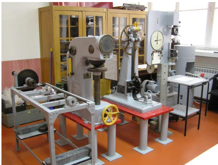
Slika 2. Manja ispitna oprema, uređaji s lijeva: torzija, Brinell, Charpy, vlačna kidalica i mala preša
