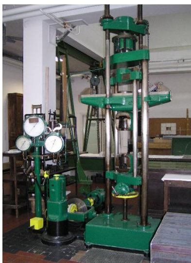
b) hidraulična univerzalna kidalica, 1921 g.
