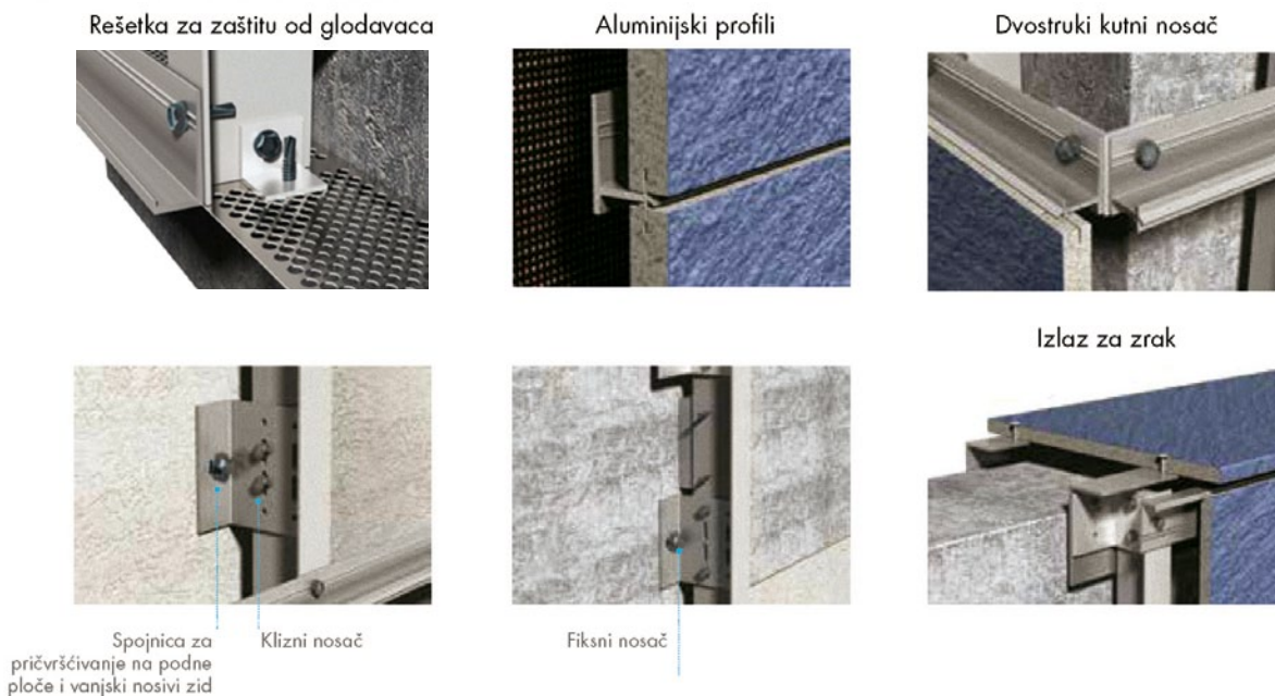
Slika 2-125 Detalji vodoravnog sustava ugradnje [136]
