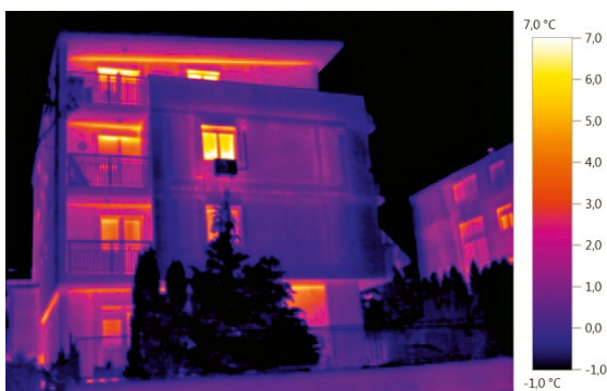
Slika 2-170 Gubici topline kroz otvore [170]
