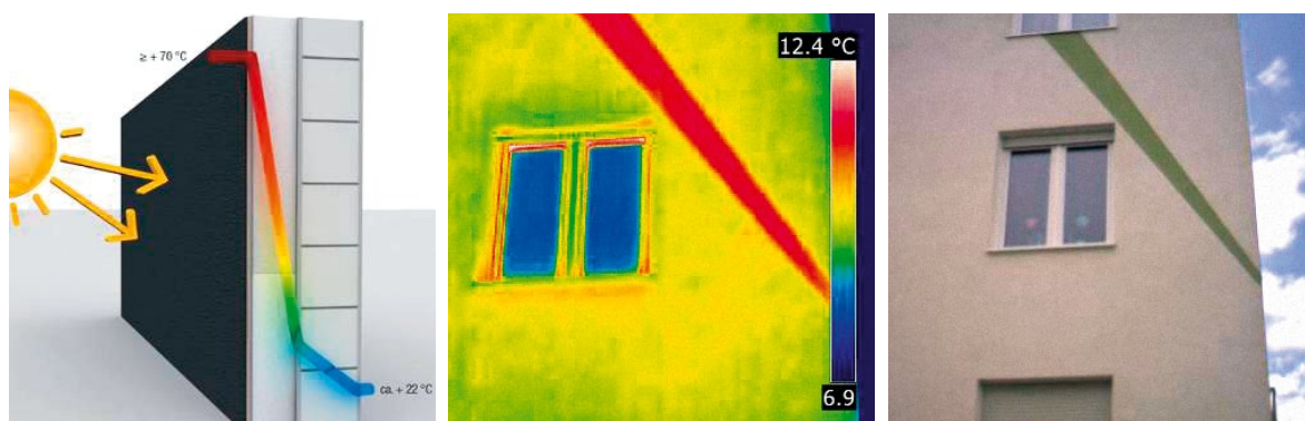
Slika 2-73 Tipična temperaturna krivulja na izoliranom vanjskom zidu, upijanje sunčevog zračenja ovisno o boji fasade [109] [110]
