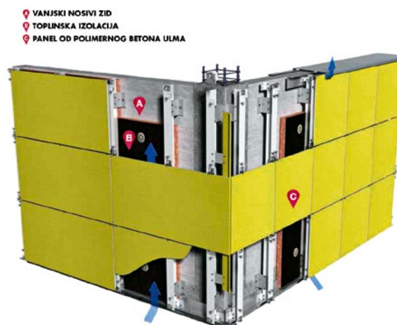
Slika 2-111 Dijelovi ventilirane fasade [136]
