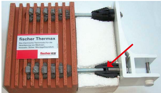
Slika 2-71 Prikaz funkcioniranja vijčanog spoja s prekidom toplinskog mosta [107]
