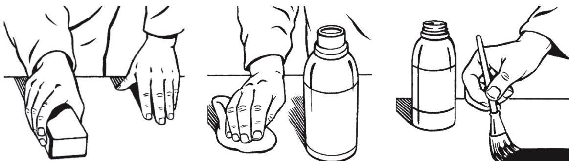
Slika 2-137 Priprema fasadnih panela [140]
