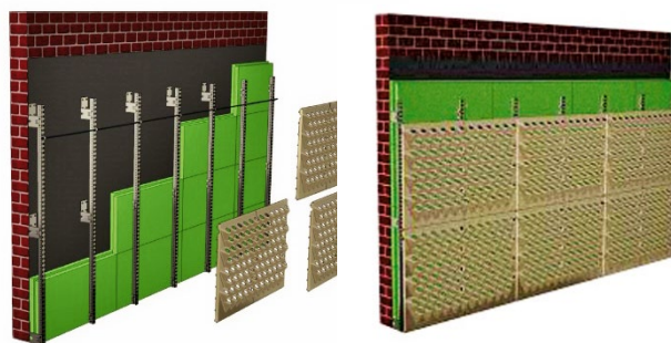
Slika 2-187 Sustavi za izvedbu zelene fasade [184]
