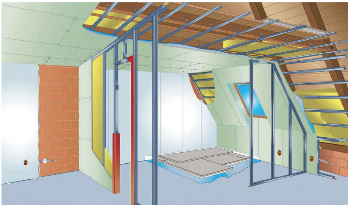
Slika 2-1 Sustavi suhe gradnje [82]
