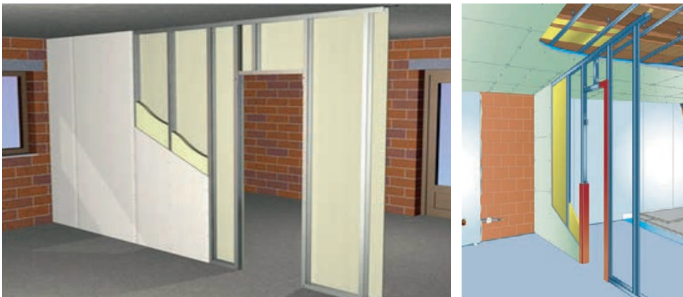
Slika 2-52 Vrata u pregradnom zidu [114], [99]
