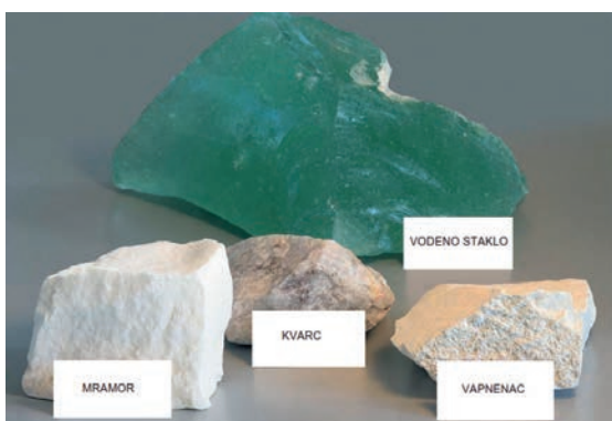
Slika 1-63 Vodeno staklo i punila u mineralnim bojama [10]
