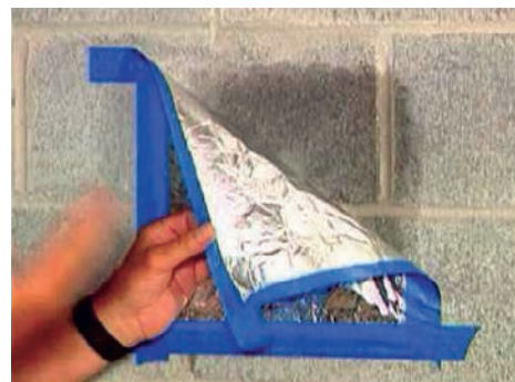
Slika 4-8 Prikaz utjecaja paronepropusnih materijala na stanje vlažnosti zida [175]
