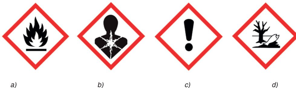
Slika 1-68 Označavanje kemikalija prema Uredbi 1272/2008/EC: a) GHS piktogram 02 (plamen); b) GHS piktogram 08 (opasnost po zdravlje); c) GHS piktogram 07 (uskličnik); d) GHS piktogram 09 (štetno za okoliš) [43]
