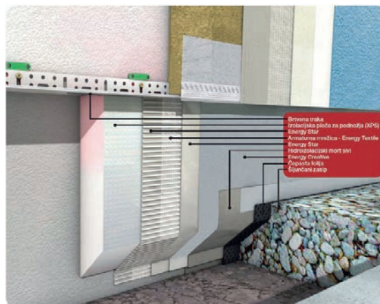
Slika 2-15 Uvučeno podnožje (sokl): a) presjek, b) vizualizacija [10]
