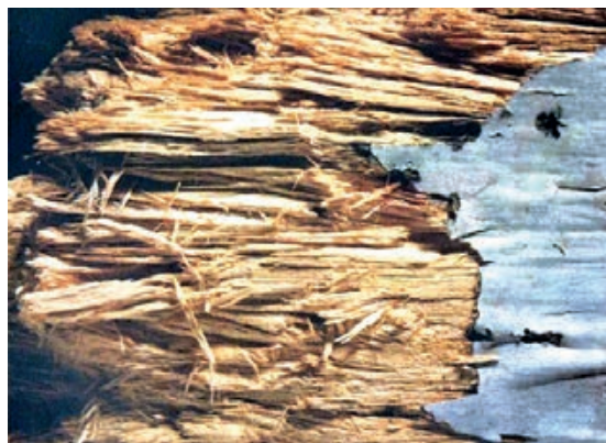
Slika 1-56 Izgled drveta razgrađenog bijelom truleži [66]
