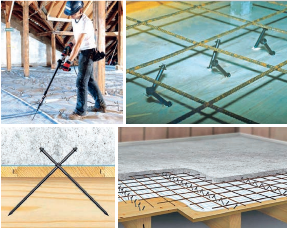
Slika 3-119 Spregnuti sustav drvo-beton [296]
