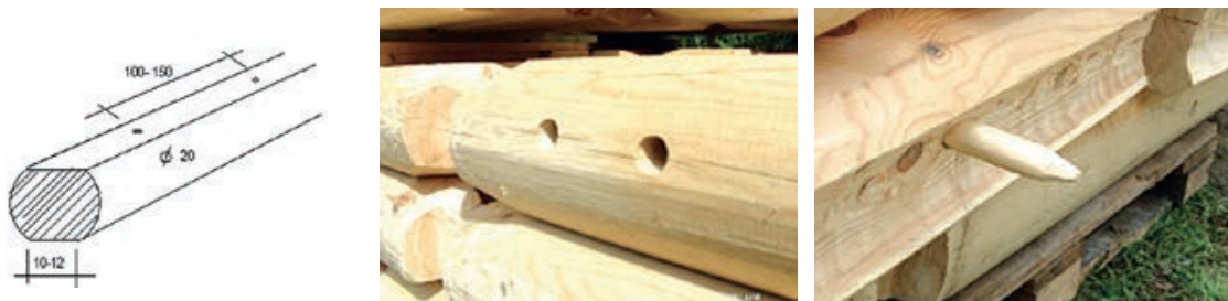
Slika 2-14 Osnovna obrada trupca u brvi [117], [161]
