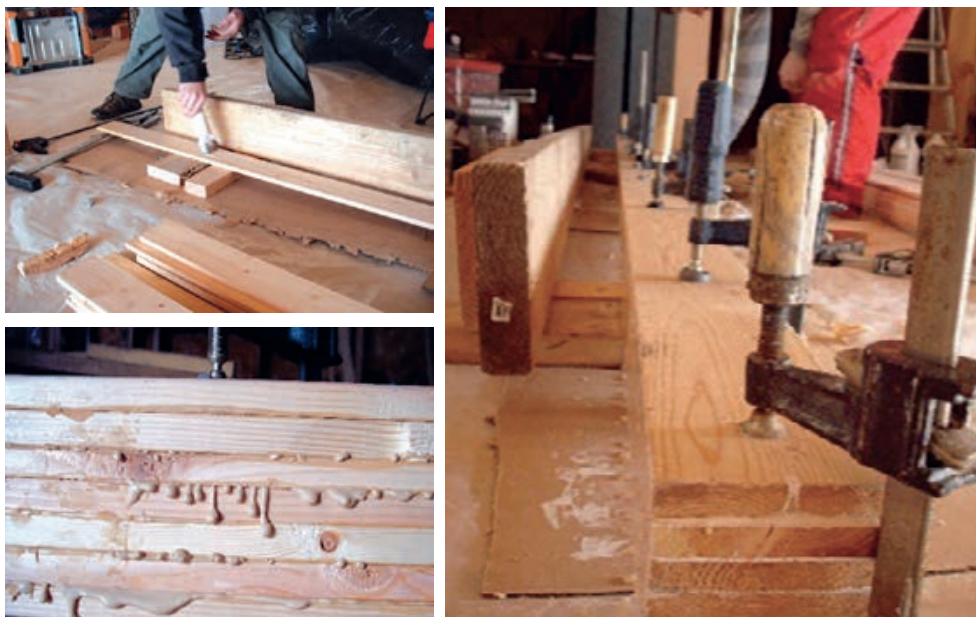
Slika 1-134 Korištenje ljepila za povezivanje lamela drva [142], [143]
