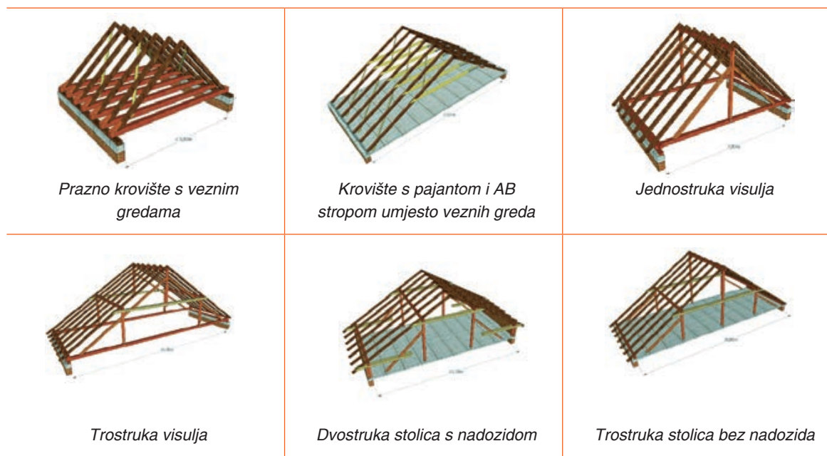
Slika 2-49 Primjeri vrsta krovnih konstrukcija [193]
