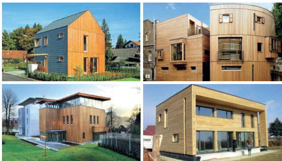
Slika 3-81 Fotografije drvenih kuća s drvenom oblogom ventilirane fasade s okapnicom i bez nje na međukatnom spoju [245]
