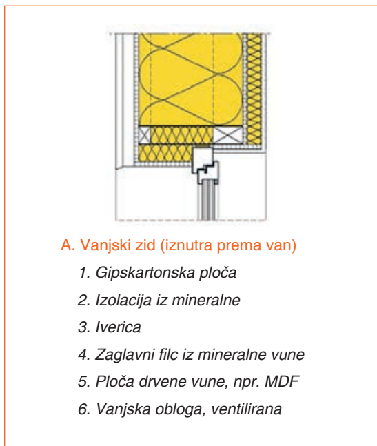
Slika 3-145 Spoj prozora s natprozornikom /dio iznad prozora – drvena okvirna konstrukcija [309]
