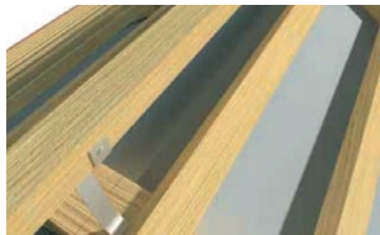
Slika 3-183 Prva opcija: letva sljemenjaka – montaža na nosač [335]
