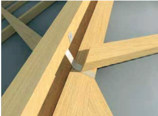
Slika 3-186 Prva opcija: letva kosine – montaža na nosač [335]
