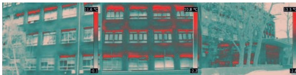
Slika 3-129 Gubici topline kroz otvore [13]
