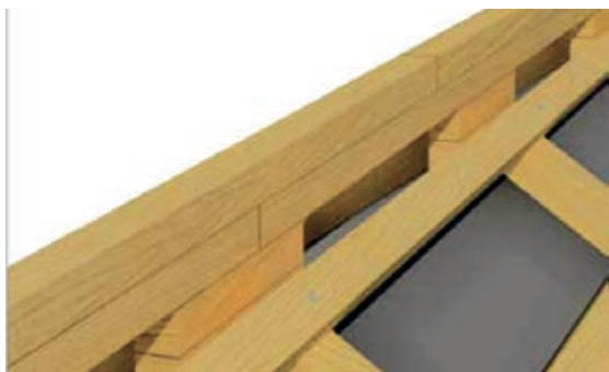
Slika 3-184 Druga opcija: letva sljemenjaka – montaža na letvenu potkonstrukciju [335]
