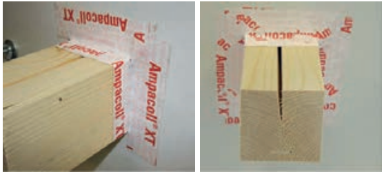
Slika 3-55 Primjeri nezabrtvljenih proboja drvenih greda zbog njihove raspucalosti (prilikom sušenja) [247]
