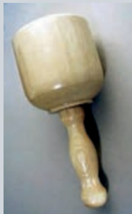
Slika 1-25 Drveni batovi različnih oblika [35], [36]
