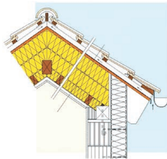
Slika 3-178 Toplinska izolacija krova u dva sloja [309]
