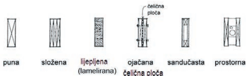
Slika 2-33 Oblici drvenih greda za skeletnu konstrukciju [178]
