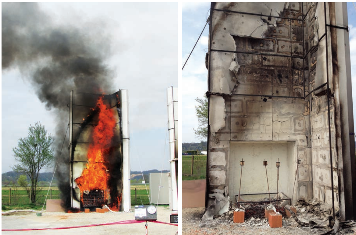
Slika 3-17 Ponašanje ETICS sustava s EPS-om tijekom i nakon požara [11]
