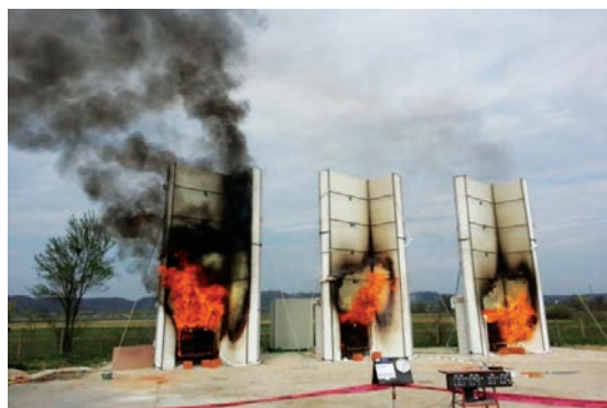
Slika 3-18 Ponašanje tri ETICS sustava tijekom požara [11]
