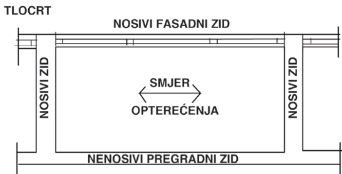
Slika 4-50 Nosivi i nenosivi zidovi
