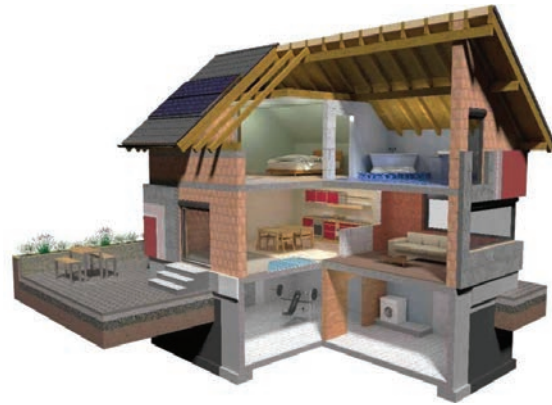
Slika 4-30 Građevni dijelovi zgrade [78]
