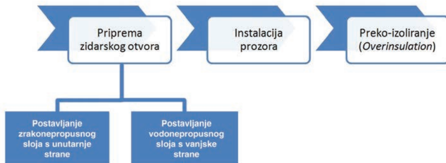
Slika 5-27 Postupak pravilne ugradnje prozora
