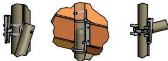
Slika 4-146 Tipovi vezanja pojedinih elemenata skele
