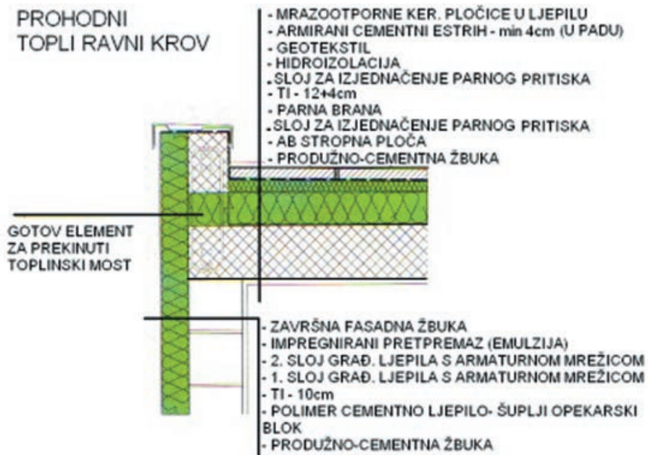
Slika 3-235 Detalj prohodnog ravnog krova [203]
