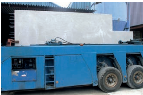
Slika 3-187 Vozilo za transport predgotovljenih betonskih elemenata [56]
