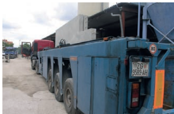
Slika 3-187 Vozilo za transport predgotovljenih betonskih elemenata [56]
