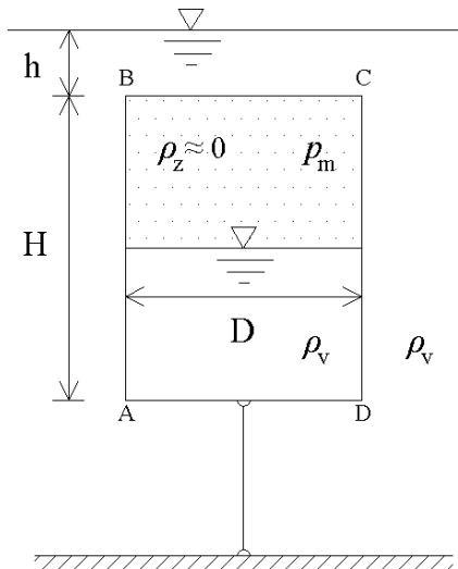
2. Kroz sistem prikazan na slici ostvaruje se protok  $Q = 35 \text{ l/s}$ , odnosno u rezervoar **R** utječe ista količina vode  $Q$  koja iz njega i istječe. Odrediti silu tlaka  $p_m$  kojom zrak djeluje na kružni poklopac rezervoara cilindričnog oblika, promjera 5 m. Nacrtati u pogodnom mjerilu energetsku i piezometarsku liniju.
