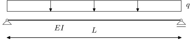
Ritzovom metodom, umjesto diferencijalne jednadžbe progibne linije savijanja štapa, rješavamo problem minimizacije potencijalne energije u diskretnom obliku. Funkciju progiba aproksimiramo linearnom kombinacijom konačnog broja ( $k$ ) koordinatnih funkcija ( $\varphi_i, i = 1, \dots, k$ )
