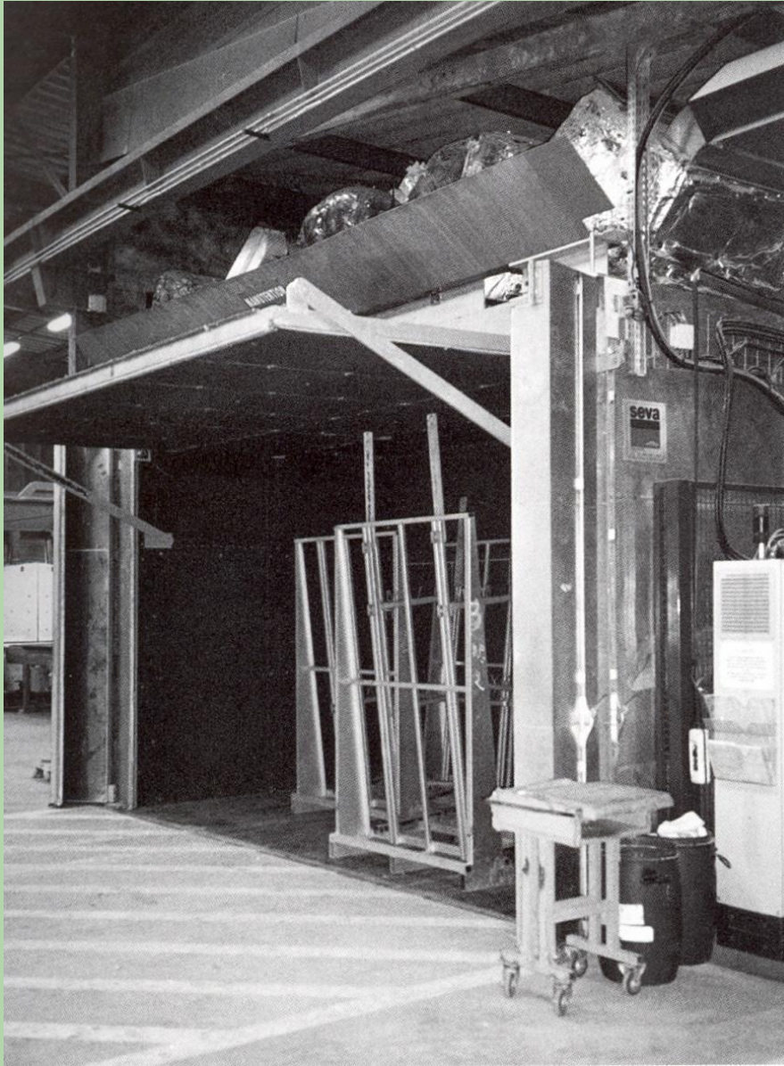
Komora za inspekciju stakla prije ugradnje (heat soak)
