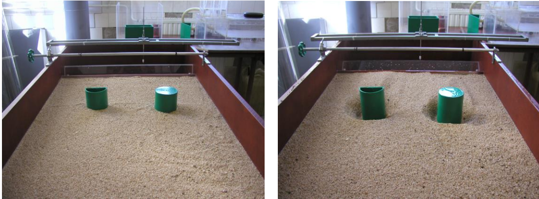
Slika 14.4 Model prije početka procesa erozije (lijevo) i nakon formiranja erozionih jama (desno)
