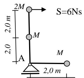
4. (20 bodova) Prikazati i objasniti izvod zakona promjene kinetičke energije. Riješiti zadatak primjenom navedenog zakona: Prikazani sustav miruje pridržan tako da opruga nije deformirana. U jednom trenutku pridržanje se ukloni i sustav se počne gibati. Treba odrediti
