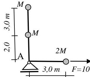
4. (20 bodova) Prikazati i objasniti izvod zakona promjene kinetičke energije. Riješiti zadatak primjenom navedenog zakona: Prikazani sustav miruje pridržan tako da opruga nije deformirana. U jednom trenutku pridržanje se ukloni i sustav se počne givati. Treba odrediti
