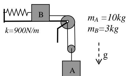
5. (20 bodova) Nabrojati i ukratko objasniti postupke određivanja diferencijalne jednadžbe slobodnih oscilacija. Riješiti zadatak: Sustav miruje u pridržan u **vertikalnoj** ravnini tako da opruga nije deformirana. U jednom trenutku pridržanje se ukloni. Treba odrediti:
